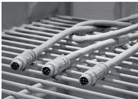
Рис. 1. Соединители M12 в камере холода
