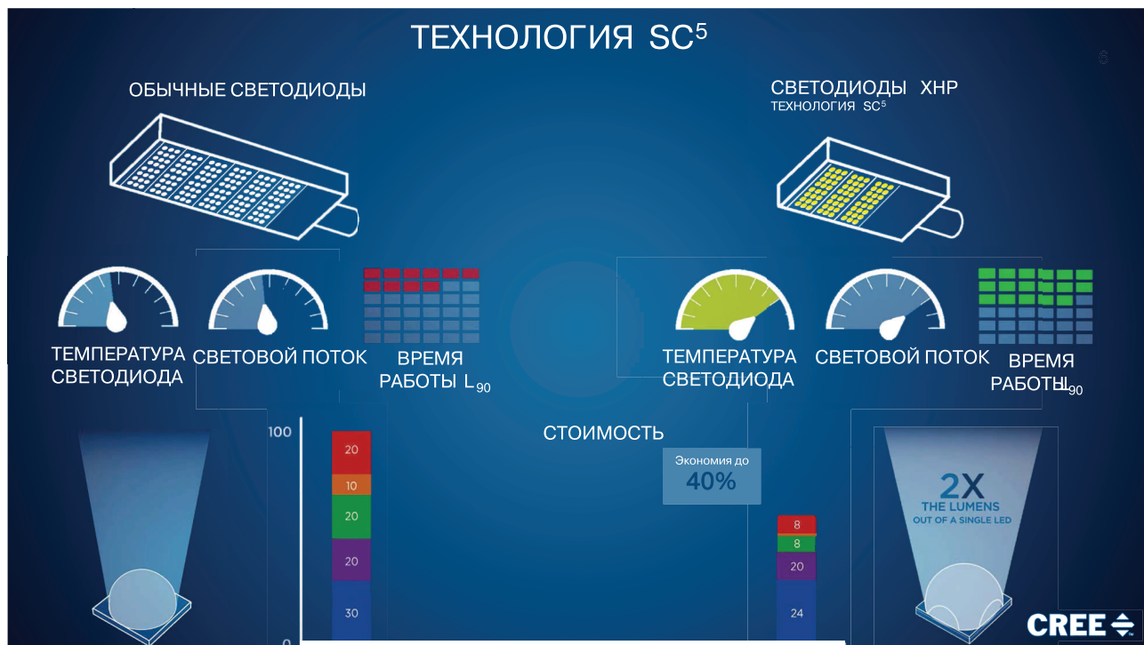
Рис. 5. Иллюстрация преимуществ светодиодов XHP, выпускаемых по технологии SC 5
