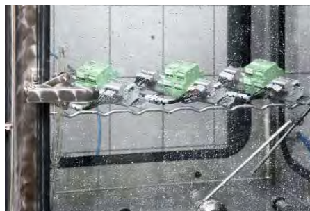
Рис. 3. Климатические испытания маркировочных материалов
