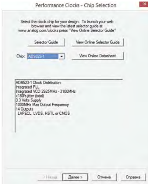
Рис. 5. Рабочее окно выбора ИМС тактового генератора Performance Clocks – Chip Selection
