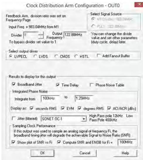
Рис. 13. Окно с параметрами выходных сигналов
