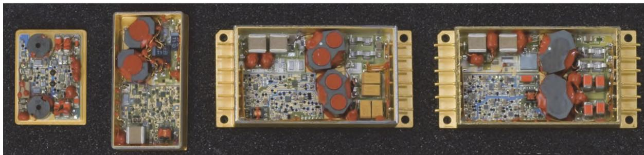
**Рис. 3. DC/DC-преобразователи класса Hi-Rel**
