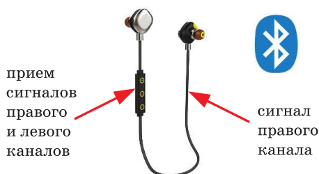
Рис. 1. Типовая схема подключения Bluetooth-наушников
