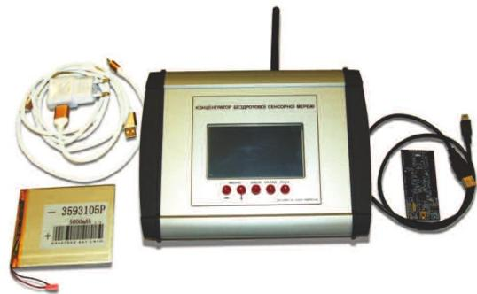
**Рис. 8. Концентратор беспроводной сенсорной сети**
