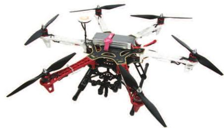
**Рис. 12. Беспилотный гексакоптер как мобильная платформа беспроводной сенсорной сети**
