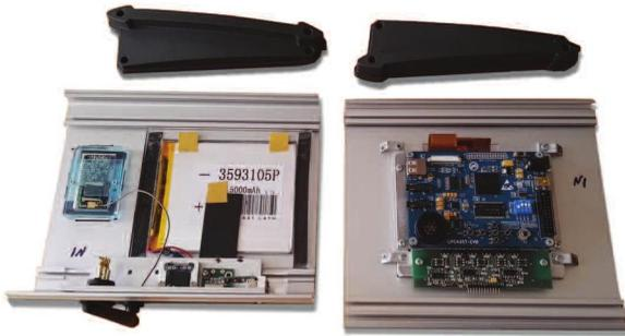
**Рис. 9. Основные узлы концентратора**
