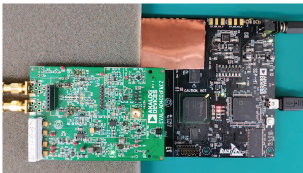
Рис. 3. Пример экранирования узлов на печатной плате, излучающих помехи
