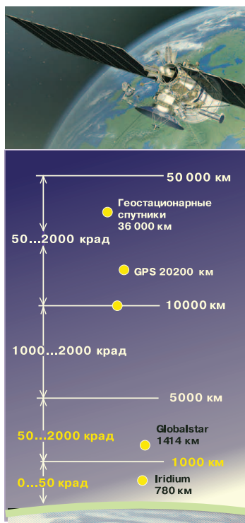
Рис. 1. Ориентировочное распределение накопленной дозы радиации в зависимости от высоты орбиты и типа спутников
