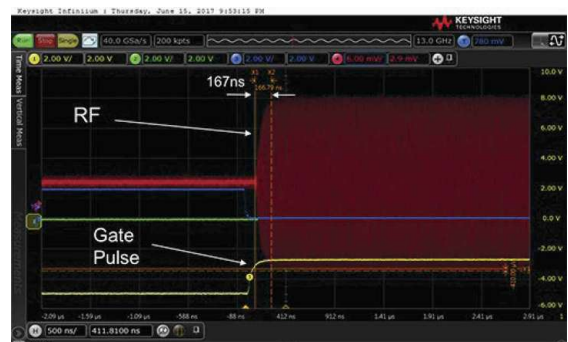
Рис. 4. Осциллограмма включения усилителя
