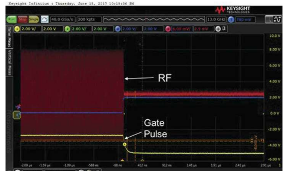
Рис. 5. Осциллограмма выключения усилителя
