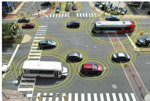
Рис. 4. Пример взаимодействия автотранспорта в транспортной сети города при помощи технологии DSRC
