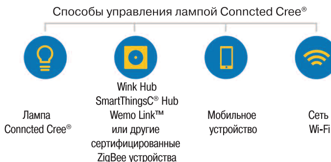
Рис. 7. Способы управления лампой Connected Cree
