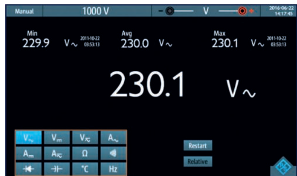
Рис. 8. Відображення вимірюваних мультиметром даних на екрані осцилографа
