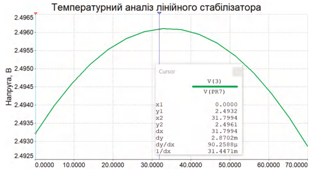
Рис. 2. Результати аналізу залежності вихідної напруги від температури
