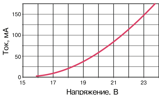
Рис. 2. Вольтамперная характеристика светодиода XLamp MX6S
