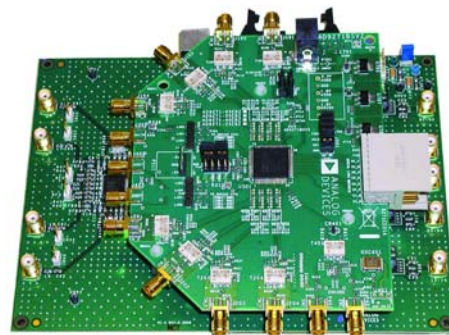
Рис. 6. Оценочная плата AD8339-EVALZ с источником входного сигнала AD9271-EVALZ
