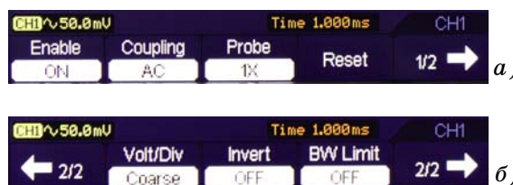
Рис. 5. Первая (а) и вторая (б) страницы меню выбора параметров первого канала вертикального отклонения
