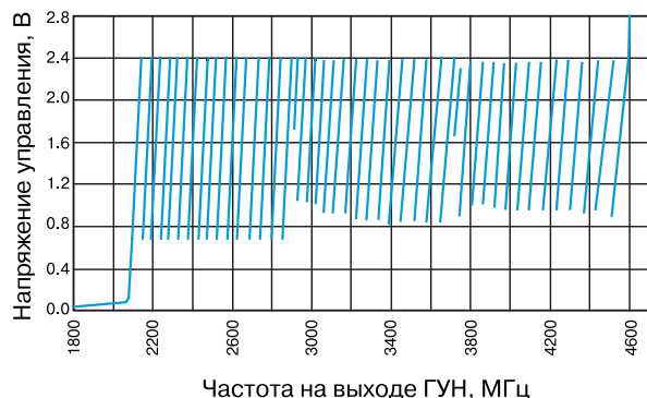
Рис. 2. Зависимость выходной частоты ГУН от напряжения управления
