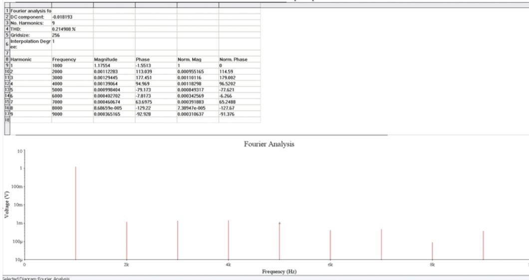
Рис. 10. Результаты Фурье-анализа сигнала на выходе усилителя UсD
